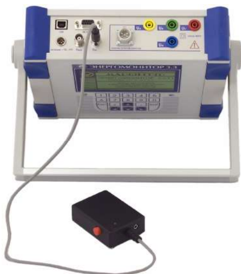
Рис. В.13. Схема подключения ПФИ к Прибору ЭМ-3.3Т1 при проверке индукционных и электронных (с оптическим импульсным выходом) счетчиков
