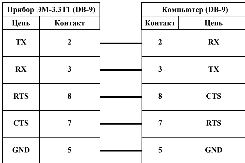
Рис. А.1. Схема кабеля для соединения Прибора ЭМ-3.3Т1 с ПК (МС6.705.003) по интерфейсу RS-232
