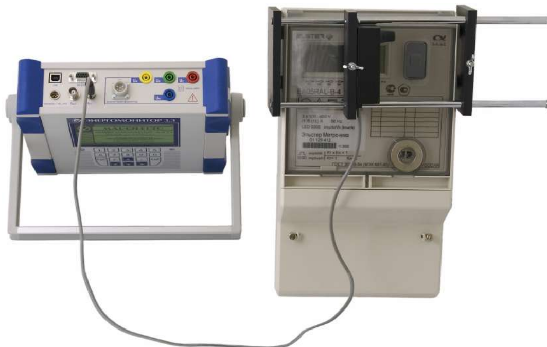
Рис. В.11. Схема подключения Прибора ЭМ-3.3Т1 к поверяемому счетчику с оптическим импульсным выходом через УФС-Э
