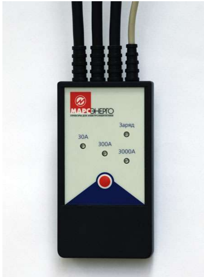
Рис. Б.10. Трехдиапазонный усилитель токоизмерительных клещей на 300 / 3000 А с блоком выбора рабочего предела
